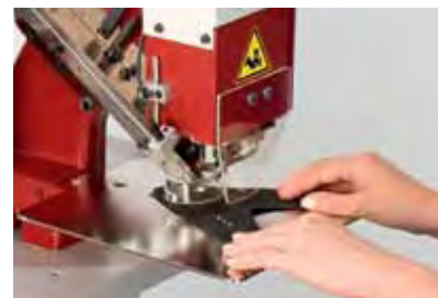
3 Coloque el material de soporte y realice la aplicación.
