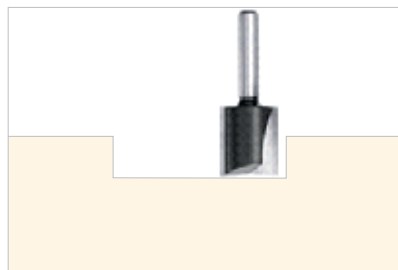
Fresado de una cavidad adicional para Crystal Gloss
