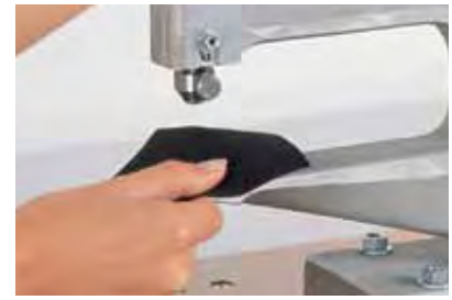
3 Aplique el producto en el tejido en la posición previamente marcada. Regule la presión utilizando el tope ajustable.
