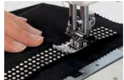
Basic Bandings (múltiples filas) Cosa la banda entre la primera y segunda fila de cristales y en caso necesario refuerce las esquinas con una puntada en zigzag.
