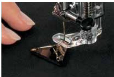
Sew-on Stones Desactive el dispositivo de alimentación inferior y ajuste la anchura de la puntada al producto.
