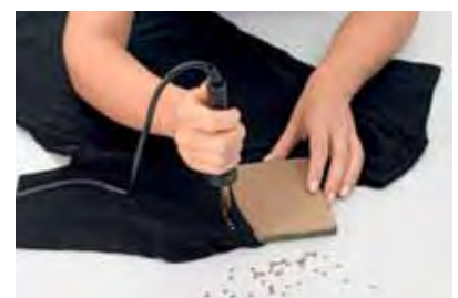
3 Tan pronto como el adhesivo Hotfix de la parte trasera del cristal se haya fundido, coloque el elemento sobre el material de soporte, que deberá estar situado sobre una base sólida (p ej. vidrio, metal)
