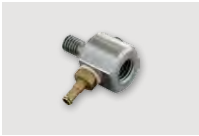
Adaptador de aspiración con rosca exterior M6 para fijar a la prensa de husillo y rosca interna M8 para sujetar el troquel superior. Art. 9040/023
