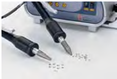
1 Seleccione un adaptador que corresponda con el tamaño del cristal
