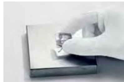
3 Presionar sobre el cristal hasta que el pegamento cubra completamente la zona de pegado.
