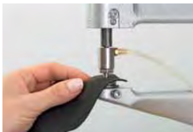
2 Coloque el material de soporte y realice la aplicación. Regule la presión utilizando el tope ajustable.
