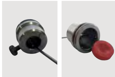
2 Utilice el pasador de cambio para deslizar lentamente el molde de silicona fuera del troquel de fijación desde arriba, a través del orificio.
