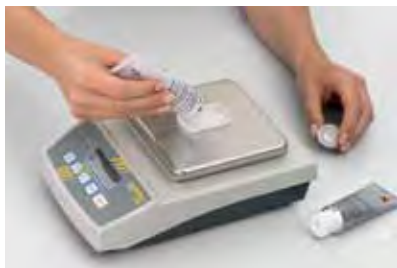
1 Pesar los dos componentes del pegamento a una relación de 1 : 1.
