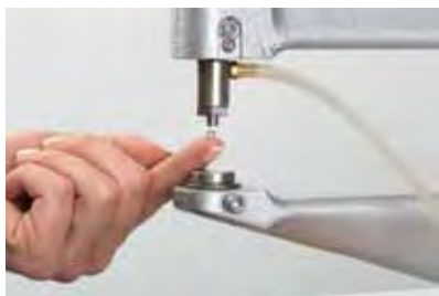
1 Coloque el Rose Pin en el troquel superior.
