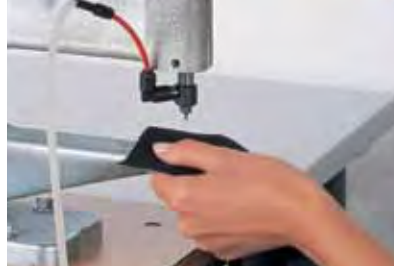
5 Coloque el material de soporte y realice la aplicación. Regule la presión utilizando el tope ajustable.
