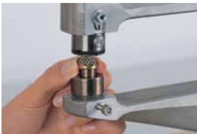
1 Coloque la parte superior del Jeans Button en el troquel superior.
