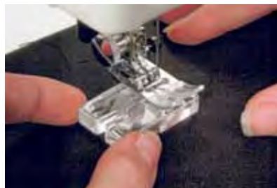
Coloque el material de ayuda para Sew-on Stone 3265 bajo el pie y elija un programa para coser botones o una puntada en zigzag. El dispositivo de alimentación inferior debe estar desactivado.
