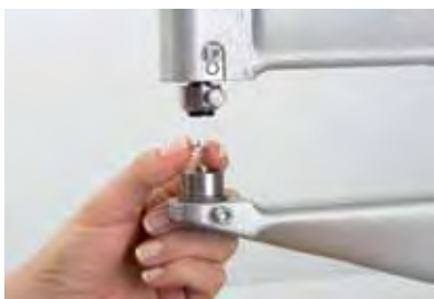
1 Coloque el anillo dentado en el troquel inferior, con las garras hacia arriba.
