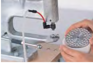
1 Coloque el cargador giratorio en el aro.
