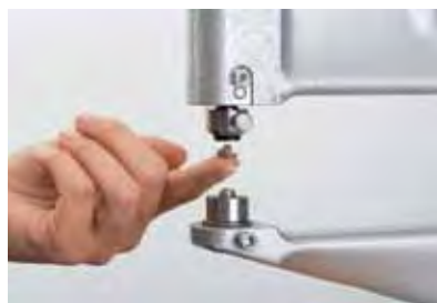
2 Coloque el remache en el troquel superior.
