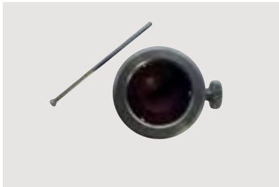
1 Para cambiar el molde según los SWAROVSKI ELEMENTS utilizados, necesitará el pasador de cambio y el nuevo molde.
