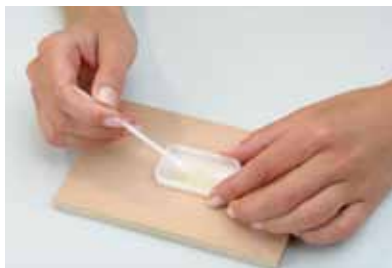
2 Mezclar bien los dos componentes al menos durante 1 minuto.
