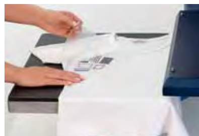
6 Cuando el producto se haya enfriado, puede retirarse la película transparente de soporte
