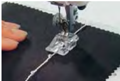
Crystal Yarn Asegúrese de que el Crystal Yarn queda en paralelo respecto al pie.
