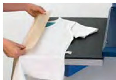
3 Asegúrese de aplicar los elementos por el lado recomendado y utilizar la base de planchado adecuada. Para proteger las superficies de calentamiento de cualquier residuo de pegamento, lo mejor es cubrir las con una película de Teflon®
