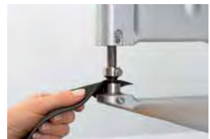
3 Aplique el producto en el tejido en la posición previamente marcada, asegurándose de que está en el lado correcto del tejido. Regule la presión utilizando el tope ajustable
