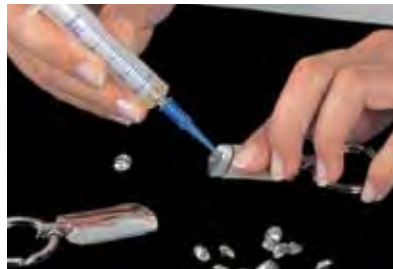
2 El pegamento debe aplicarse con un dosificador.
