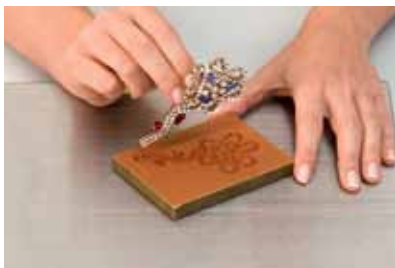
4 Una vez endurecido el molde, puede retirarse el modelo original.
