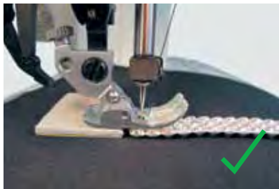
El pie descansa plano gracias al compensador de altura .
