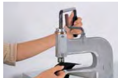
3 Realice la aplicación en la posición deseada. Regule la presión utilizando el tope ajustable.
