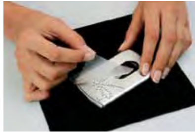
5 Cuando el pegamento se haya endurecido, retire la película transparente (teniendo en cuenta la información técnica del pegamento).
