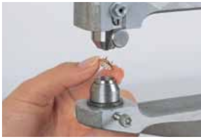
1 Coloque el Decorative Button/parte superior del Snap Fastener en el troquel inferior, con las garras hacia arriba.
