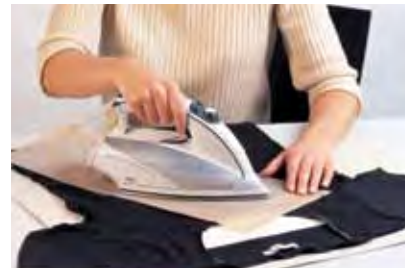
3 Una hoja de Teflon® protege la base de la plancha de cualquier residuo de pegamento
