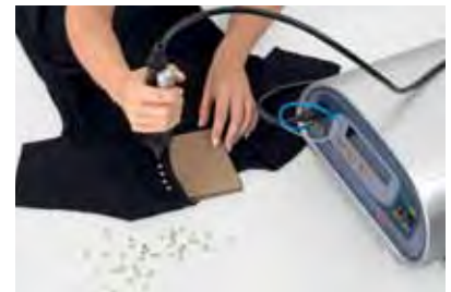
3 Presione el adaptador firmemente contra el cristal en un ángulo perpendicular y active el dispositivo
