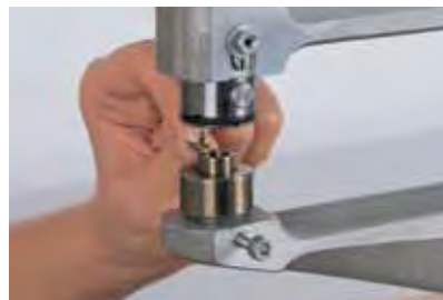
2 Coloque el pasador de flecha en el troquel inferior.
