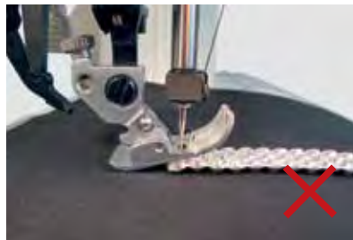
Un prensateles inclinado puede provocar problemas con la alimentación del material base.
