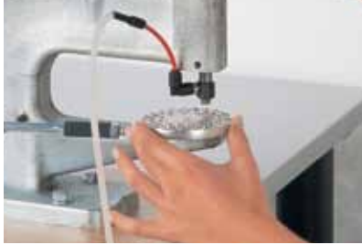
4 La bomba de aspiración succionará los Rivets.
