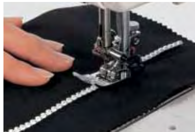
Basic Bandings (una fila) Asegúrese de que el Basic Banding queda en paralelo respecto al pie.
