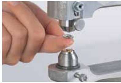
2 Coloque la base convexa en el troquel superior.
