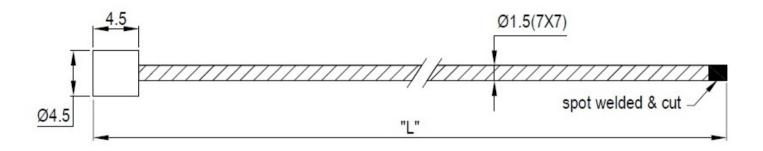
Cable diameter:1.5MM Cable construction:7X7
