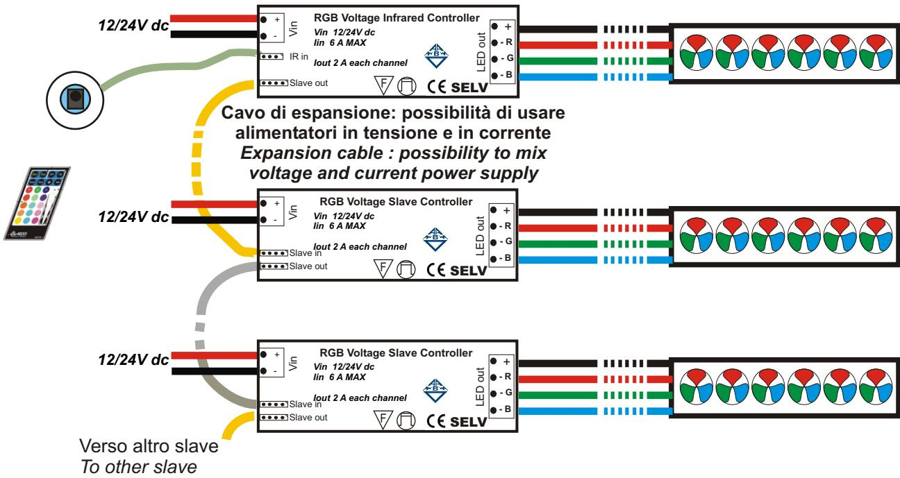
Cavi di ingresso: 1x H03VVH2-F (2x0,75mm<sup>2</sup>) - Cavi di uscita: 2x H03VVH2-F (2x0,75mm<sup>2</sup>)
